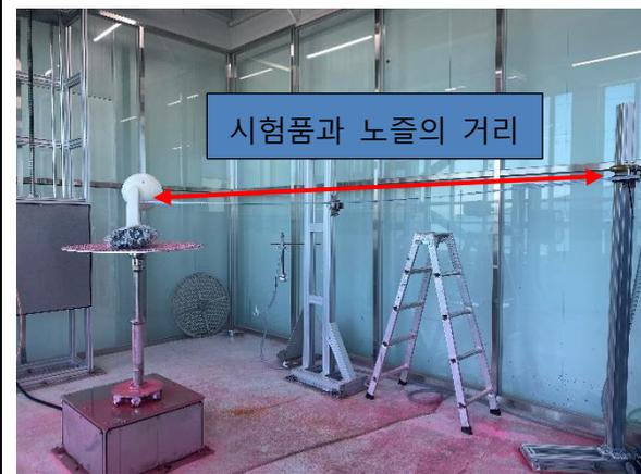
그림 12) 시험품 장착 사진 (거리 측정)
