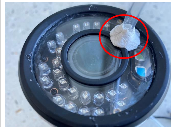
그림 6) 감압 호스 설치 사진 #2
